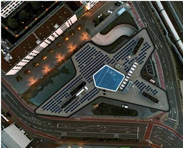
*Highlight: Die Kleeblattform aus der Luft. Um den Glasbereich herum sind PV-Module angeordnet.*
