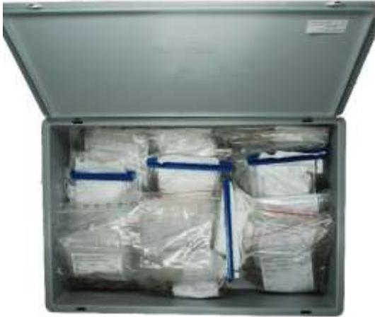
Abb.: „Klimabox“ - EN-Box mit Konditionierung und abdichtendem Silikonprofil (Tom Stöckl)
