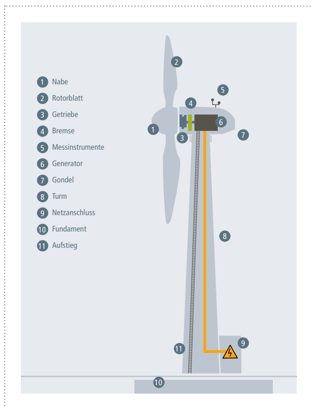
Abbildung 1: Aufbau einer Windenergieanlage Quelle: Eigene Darstellung
